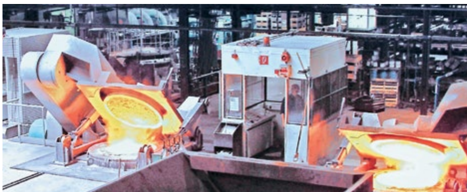
Moderne Mittelfrequenz- Induktions-Schmelzöfen, ACO Kaiserslautern
